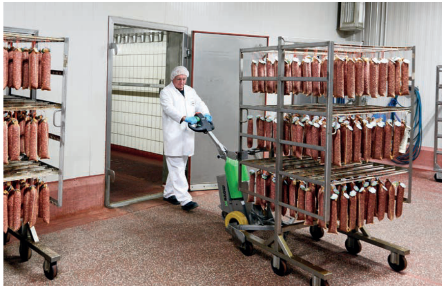
Heute werden die Rauchwagen dank der Spezialanfertigung einer elektrisch betriebenen Transporthilfe kraftsparend und rückschonend bewegt.
